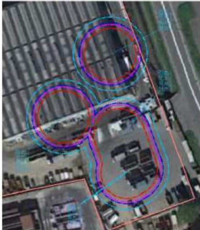
Figura 6 – Aree di danno da incendio di pozza che fuoriescono dai confini di stabilimento (riportati in rosso)
